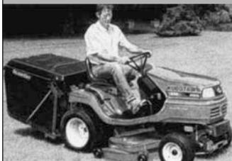
G18 · 3-Messer Heckauswurfmäherwerk · Schneiden & Mähgutauffang in einem Arbeitsgang · 122 cm Schnittbreite · Schnitthöhe 25 bis 102 mm, Einstellung vom Fahrersitz aus · 13,4 kW - Drei-Zylinder - Kubota-Dieselmotor · Servolenkung · Auf Wunsch mit hydr. Hochentleerung · Optional: eine große Auswahl an Zubehör und Anbaugeräten
